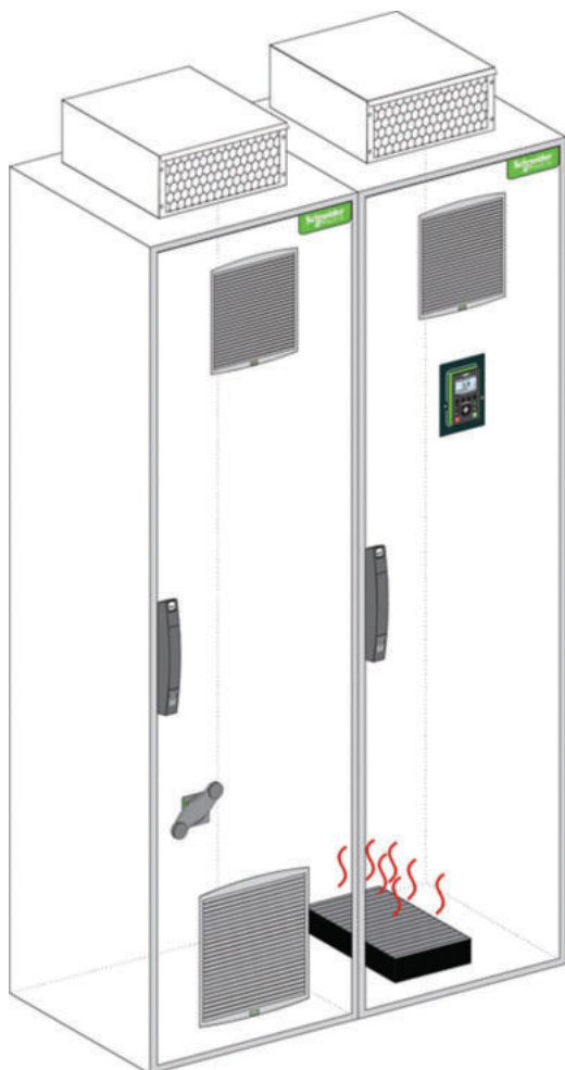
Chauffage de l'armoire
